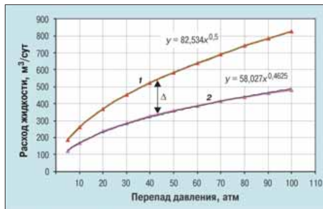
Рис. 2. Зависимость расхода жидкости от перепада давления для трубки Вентури (1) и диафрагмы (2)
