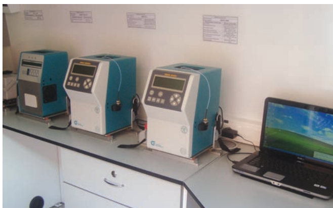
Приборы экспресс-контроля качества нефтепродуктов
