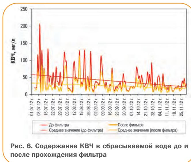
Рис. 6. Содержание КВЧ в сбрасываемой воде до и после прохождения фильтра
