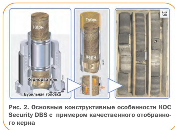
Рис. 2. Основные конструктивные особенности КОС Security DBS с примером качественного отобранного керна
