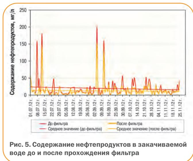
Рис. 5. Содержание нефтепродуктов в закачиваемой воде до и после прохождения фильтра
