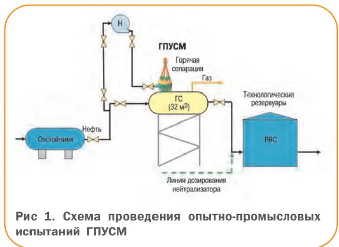
Рис 1. Схема проведения опытно-промышленных испытаний ГПУСМ
