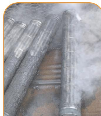
Рис. 4. Очистка фильтрующих элементов с помощью ППУ
