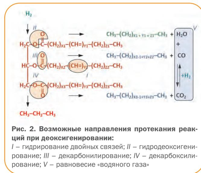
В ходе реакций декарбоксилирования и декарбонилирования получаемые углеводороды имеют на один атом углерода меньше, чем в исходной жирной кислоте. Кроме того, образующаяся в ходе гидродеоксигенирования вода может способствовать гидролизу сложных эфиров с образованием глицерина и кислот и участвовать в реакциях равновесия «водяного газа», изменяя соотношение  $CO/CO_2$  образующихся в процессе деоксигенирования.
