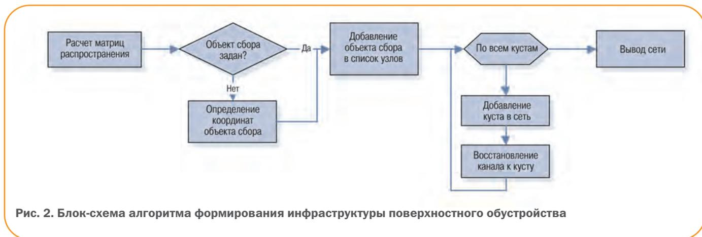
Рис. 2. Блок-схема алгоритма формирования инфраструктуры поверхностного обустройства
