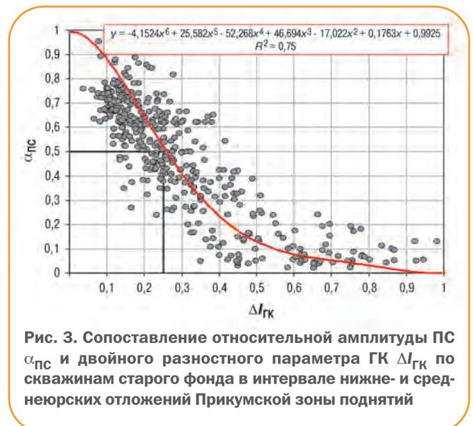
Рис. 3. Сопоставление относительной амплитуды ПС  $\alpha_{ПС}$  и двойного разностного параметра ГК  $\Delta I_{ГК}$  по скважинам старого фонда в интервале ниже- и среднеюрских отложений Прикумской зоны поднятий
