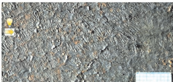
Рис. 1. Внутренняя поверхность трубы из ВЧШГ, выполненной по ТУ 1461-037-50254094-2008, с условным проходным диаметром 150 мм
