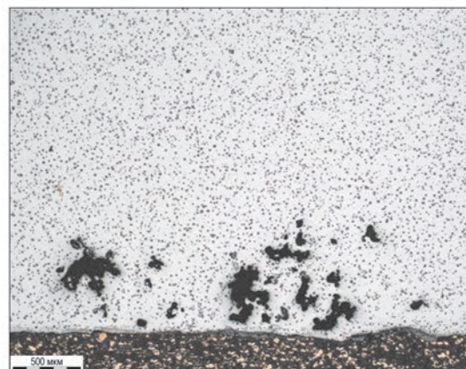
Рис. 4. Поры под поверхностью труб из ВЧШГ
