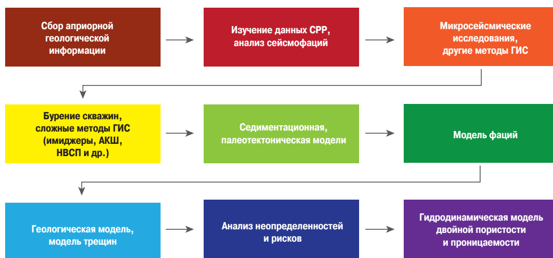
Рис. 4. Упрощенная схема алгоритма комплексирования данных для создания постоянно действующей геолого-технологической модели
