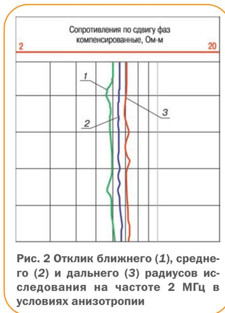
Рис. 2 Отклик ближнего (1), среднего (2) и дальнего (3) радиусов исследования на частоте 2 МГц в условиях анизотропии
