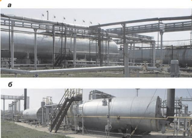
**Рис. 2. Оборудование Похвистневской УКОН:** а – аппаратурный модуль УПН-3000; б – подогреватели нефти ПБТ-1,6М
