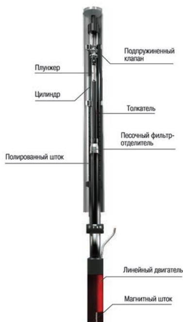
**Рис. 1.** Принципиальная схема плунжерного насоса с погружным линейным двигателем
