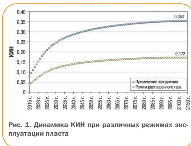
Рис. 1. Динамика КИН при различных режимах эксплуатации пласта
