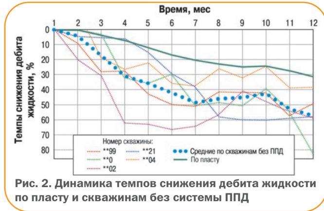
Рис. 2. Динамика темпов снижения дебита жидкости по пласту и скважинам без системы ППД
