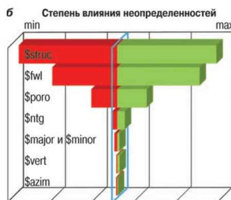
Рис. 3. Гистограмма вероятностного распределения НГЗ газа относительно базового варианта (а) и торнадо-плот чувствительности запасов к переменным анализа неопределенностей (б)
