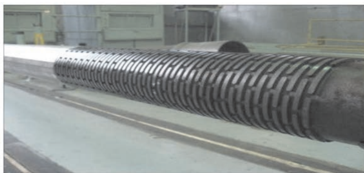
Рис. 4. Устройство контроля притока «Мягкий дроссель»
