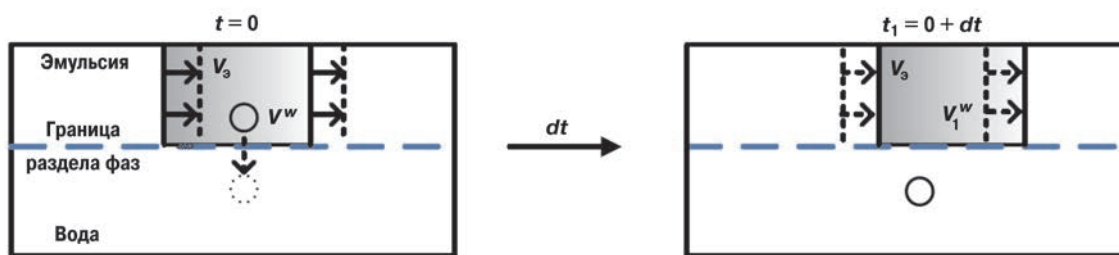
Рис. 1. Расчетная схема процесса сепарации
