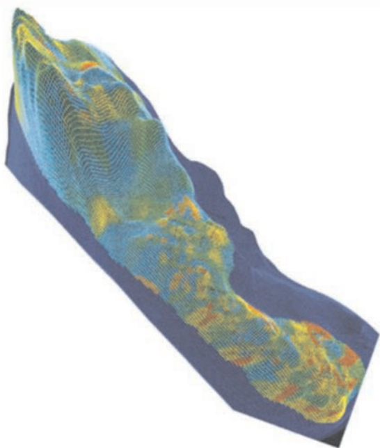
Рис. 2. Цифровая модель крупнейшего шельфового месторождения нефти Safaniya, созданная в гидродинамическом симуляторе GigaPOWERS [9]
